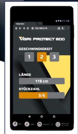
Bedienpanel zur komfortablen Einstellung der Geschwindigkeit, Länge und Stückzahl
