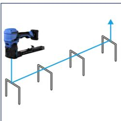
automatisches Heften: Heftklammern werden bei gedrücktem Auslöser innerhalb eines vordefinierten Zeitraums fortlaufend gesetzt.
