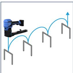
halbautomatisches Heften: Heftklammern werden bei gedrücktem Auslöser fortlaufend gesetzt.
