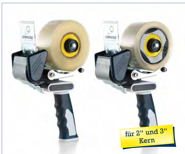
Art.-Nr. 82244 - geräuschreduzierender Abroller, stabile Metallausführung, ergonomischer Handgriff mit gummierter Griffzone, variable Bandablaufbremse, aktiver Messerschutz (Touchflap), Twincore, für Klebebänder mit 2" (50 mm) und 3" (76 mm) Kern sowie Rollenlängen von 66 m, 132 m und 150 m geeignet
